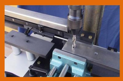
MODEL 400 POSITIONER IN USE ON A CUSTOMER'S DRILL PRESS.
